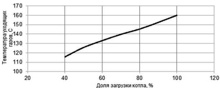
Рис. 5. Зависимость температуры уходящих газов от степени загрузки котла при 10% выработке пара за счет ТБО
